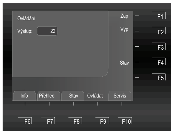
Obr. 58: Odpojení výstupu 22 (příklad)
