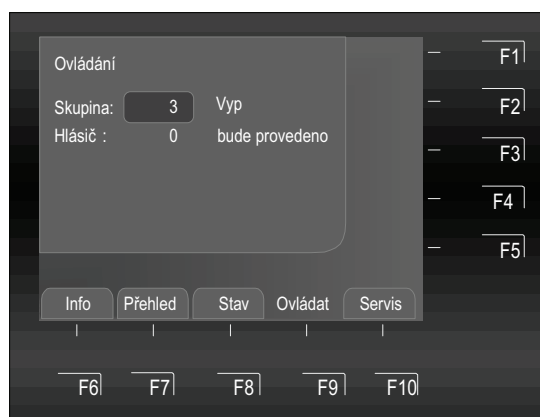
Obr. 40: Zobrazení odpojení pro skupinu 3 (příklad)
