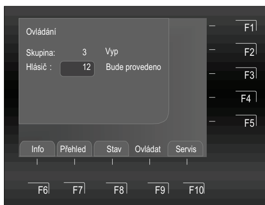
Obr. 57: Zobrazení zapnutí/resetu řízení 22 (příklad)
