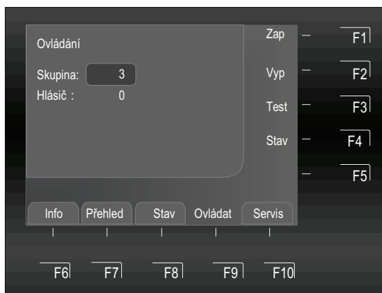
Obr. 47: Odpojení hlásiče 12 skupiny 3 (příklad)
