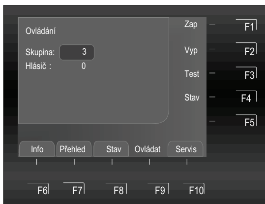
Obr. 53: Hlásič 12 (ze skupiny 3) – zjištění stavu (příklad)
