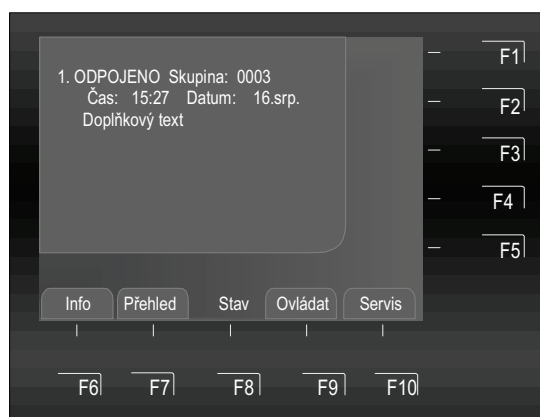
Obr. 40: Zobrazení odpojení pro skupinu 3 (příklad)
