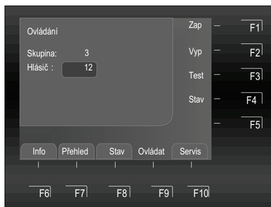
Obr. 45: Zapnutí/reset hlásiče 12 (skupina 3) (příklad)
