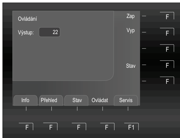
Obr. 56: Zapnutí/reset řízení 22 (příklad)
