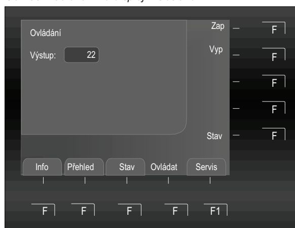
Obr. 36: Zapnutí/vypnutí řídicí skupiny 22 (příklad)
