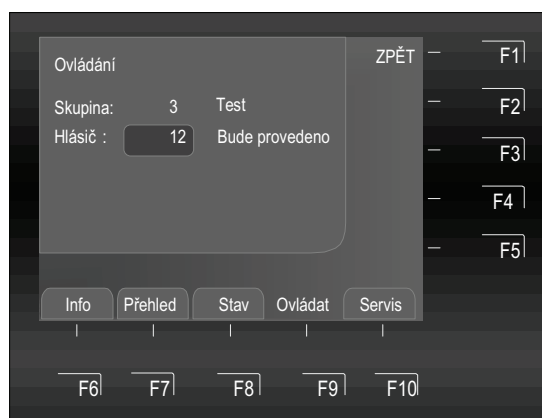
Obr. 52: Hlásič 12 (ze skupiny 3) s aktivovanou zkušební funkcí (příklad)
